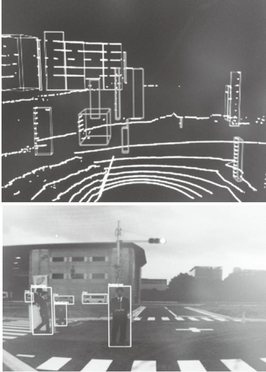
Fig.4 ライダ(上)とカメラ(下)による障害物検知の結果
