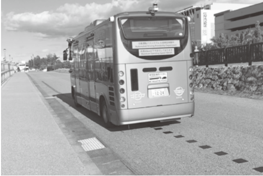
Fig.10 磁気マーカーによる正着制御
