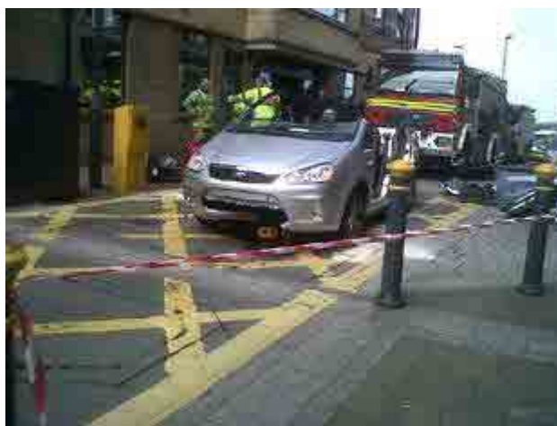
写真 4-1：ボラードによる違反車両の突き上げ事故 4)
