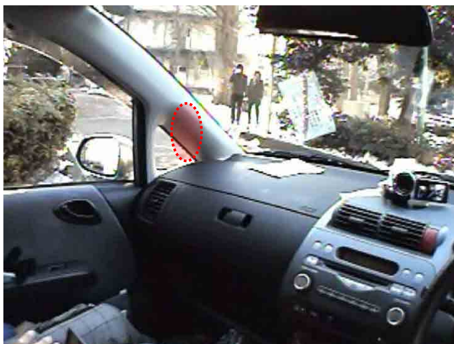
写真 4-7 ボラードが車両の一部と重なった場合
