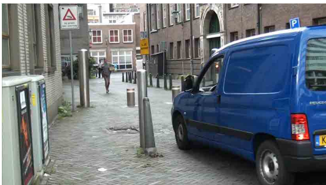
図 2-6 デンハーグ市のライジングボラードの様子
