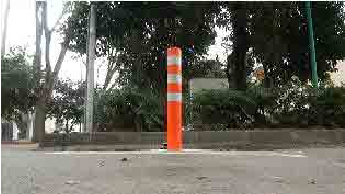
写真 4-13 車両通過後のボラード
