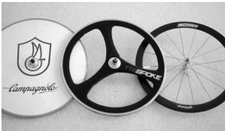
Fig. 8 空気抵抗の軽減をねらった車輪
