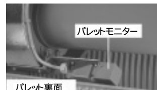
Fig. 13 パレットモニター安全装置
