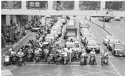
待ちスペースは十分ではないが、オートバイを一定のエリアに停車するように誘導する役割を果たす
