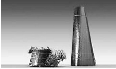
Fig. 2 CFRPフロントサイドメンバ 5)
