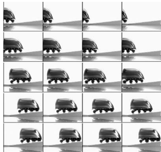
Fig. 11 レベリング動作例：坂道走行
