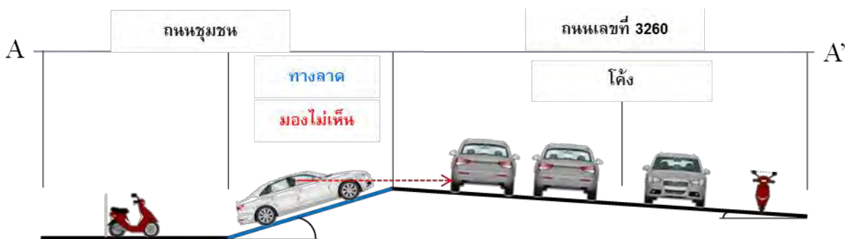
รูปที่ 6-16 ทางที่ตัดกันของทางโค้ง (ด้วยเงื่อนไขที่มีอยู่) ที่มองไม่เห็น
