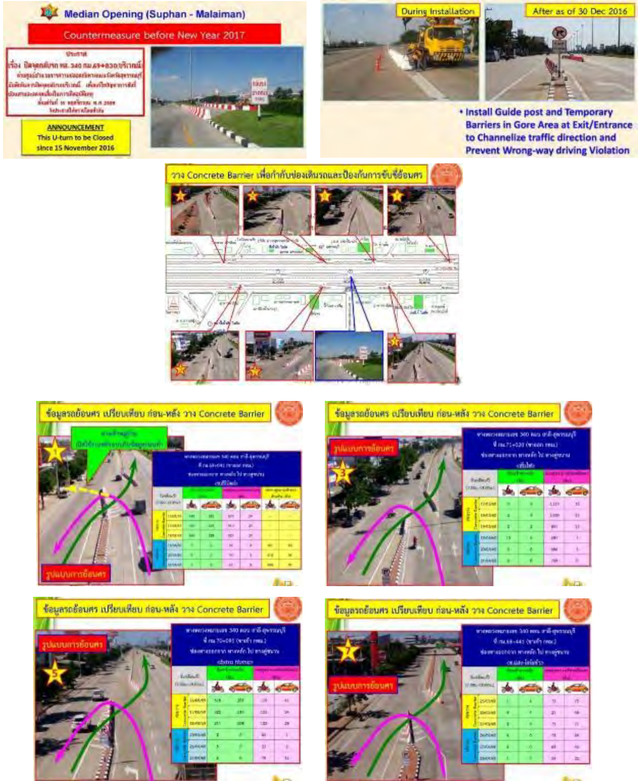
รูปที่ 8-28 ที่กั้นคอนกรีตไม่ให้ขับรถในช่องทางที่กำหนดและการเปรียบเทียบรถที่ฝ่าฝืนกฎจราจรก่อนและหลังการใช้งาน
