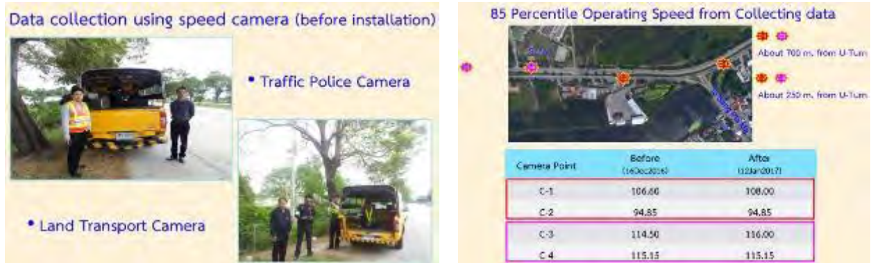
รูปที่ 8-9 การเปรียบเทียบข้อมูลความเร็วก่อน/หลังใช้อุปกรณ์เตือนภัย
