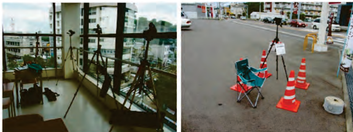
図 3-49 ビデオカメラによる交通流調査(左:建物からの撮影, 右:地上部からの撮影(信号現示))
