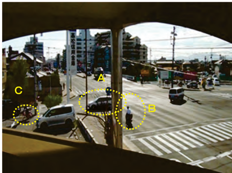
図 3-28 事例 4: 対向右折車が対向車線上で停止したための直進車との交通コンフリクト(地点 4)
