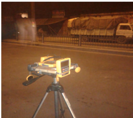
写真-3 道路・沿道空間での照度の計測風景
