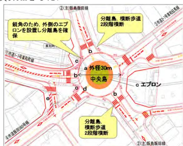
図-C2.3.2 十字のラウンドアバウト(外径27m) 図-C2.3.3 5枝ラウンドアバウト(外径30m)
