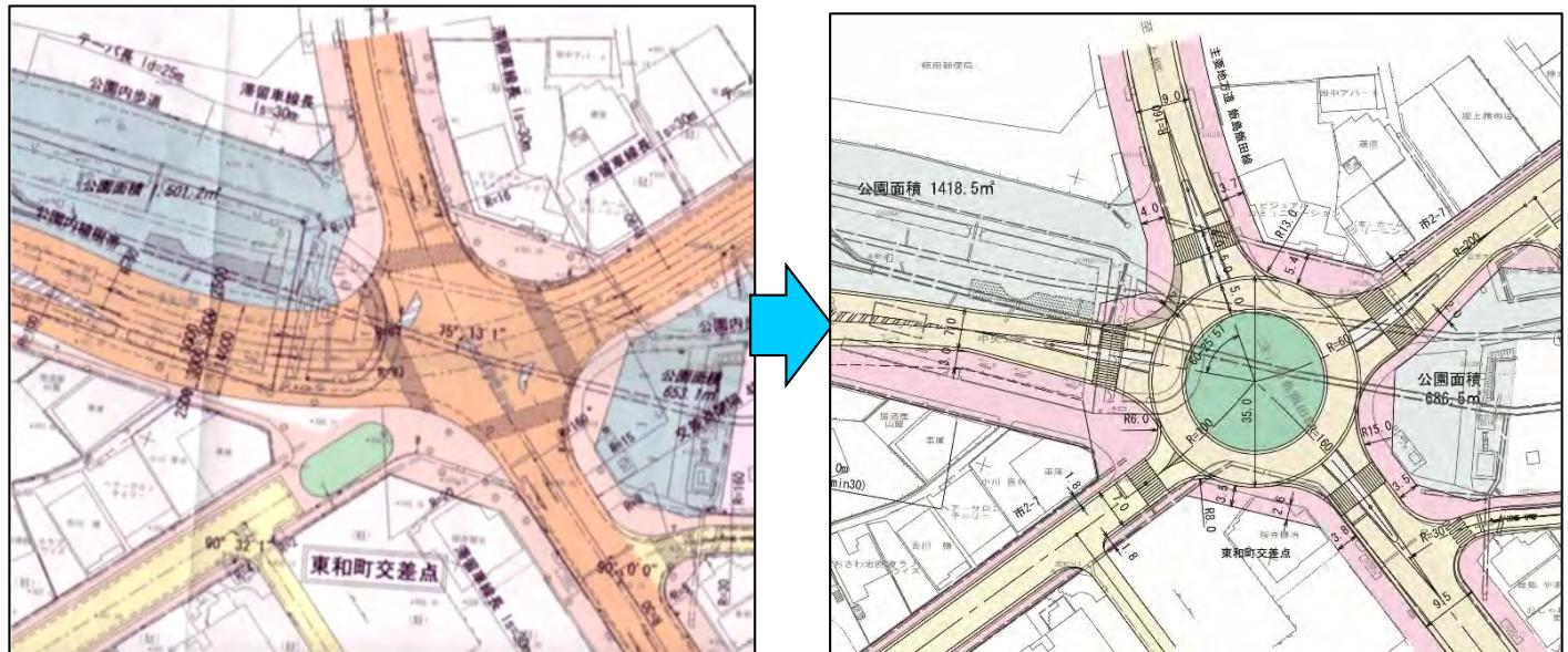
図-C2.1.3 4枝の信号交差点(左)と外径35mのラウンドアバウト(右)：(平成21年計画)
