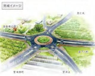
須坂市野辺町の交差点(通称A交差点)は、変則的に5方向からの交通が交錯しており、出会い頭の事故等が多く発生非常に危険な交差点形状となっています。交差点の形状や各方向の使用状況(交通量)等を考慮し、安心、安全かつ効率的で環境に優しい交差点制御として、ラウンドアバウト方式の交差点を整備します。
