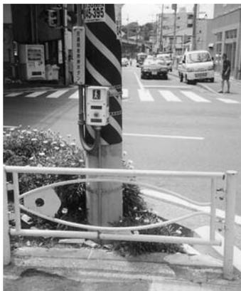
ガードを撤去して電柱の外側（植栽部と車道の境）に設置すべきである。
