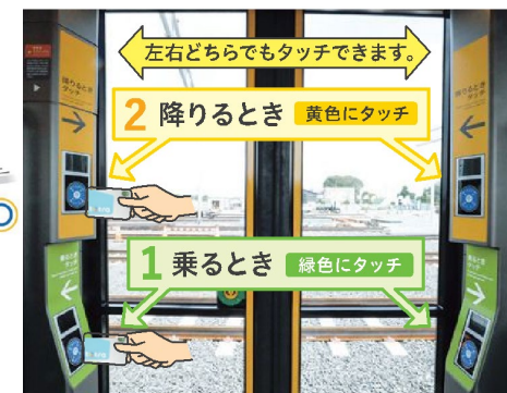
▲車両の全屏の両側に設置されたICカードリーダー
