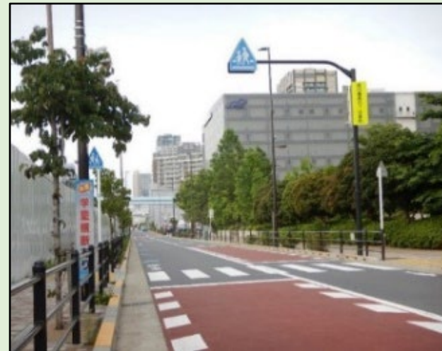
法定外表示 (視認性を高める補助的な対策) 標識大型化・カラー舗装・看板
