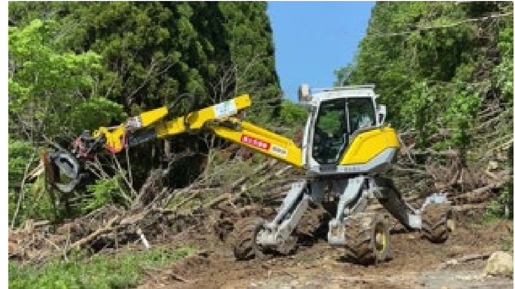
把み装置(グラップル)による倒木除去作業
