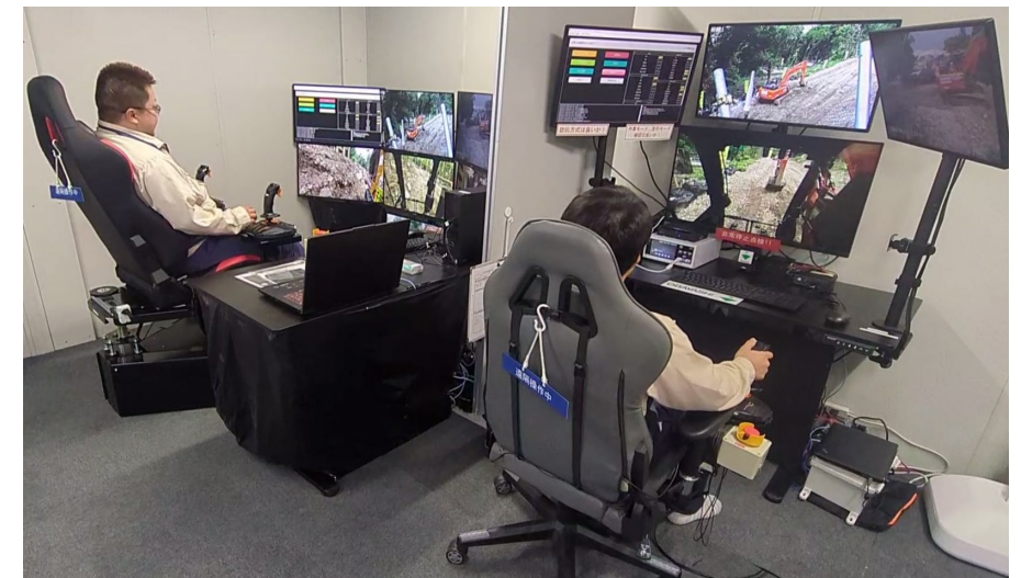
千葉県君津での遠隔操縦状況 (写真左がCD、右がBH操縦席) 20
