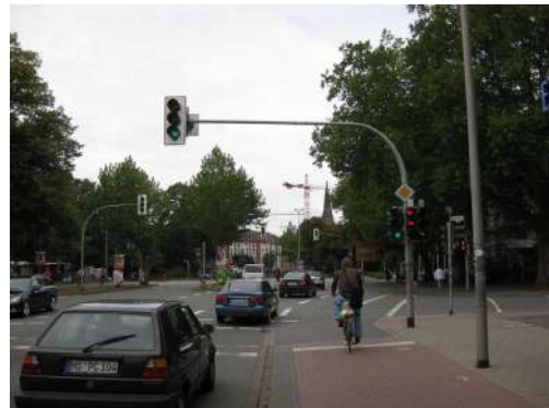
図 4-21 自転車専用信号の活用例 1 (自転車のみを先行して進行させ、右折自転車は、右折車線横の自転車専用右折車線へ誘導。 その後、自動車信号が青となる)
