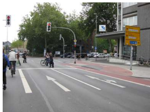
図 4-22 自転車専用信号の活用例 2 (右折自転車については、上の例と同様(但し、自転車用右折車線は特でない)。一方、 左折自転車については、専用車線から分離して歩道上に自転車走行空間を設置して いるが、直進自転車は、停止線を前出しし、そのまま直進させている。)
