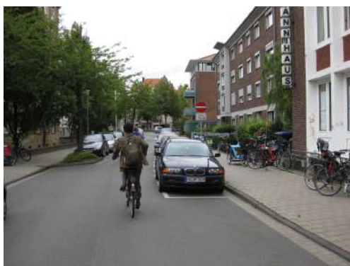
図 4-18 一方通行道路における双方向自転車通行可（ミュンスターでは、標識標示 220 に補助標識を掲示する例は見あらず、標識標示 267 に補助標識を掲示している。）
