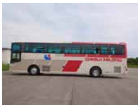
富士重工 スペースウィング スーパーハイデッカ KL-RA552RBN, 最小回転半径-10m
