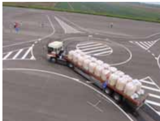
写真-4.4 走行軌跡確認実験
