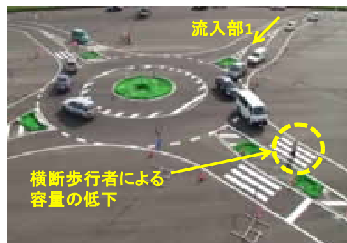
写真-7.2 実験における横断歩行者 による容量低下の例
