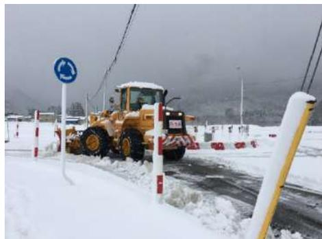
除雪ドーザーによる除雪作業
