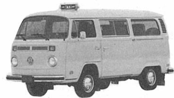
製造者名 Volkswagenwerk, Wolfsburg, West Germany エンジン ハイブリッド型原動機 (ガソリンエンジンと電)
