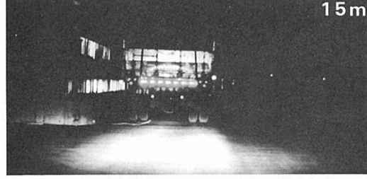
Fig. 16 車間距離による輝度パターンの変化の状況 Luminance pattern change by distances between vehicles
