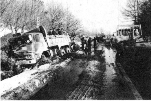
Fig. 5 スリップ事故一第1当(ダンプ車)の衝突後の停止位置 (S.54.11.21日 AM10:10発生) Skidding accidents of dumpcars and their stopped locations after collision 状況:第1当のダンプ車が左カーブのゆるい下り坂で、凍結したわだちハンドルをとられて対向して来た第2当(普通貨物車)に接触し、さらに追縦していた乗用車に正面衝突した。
