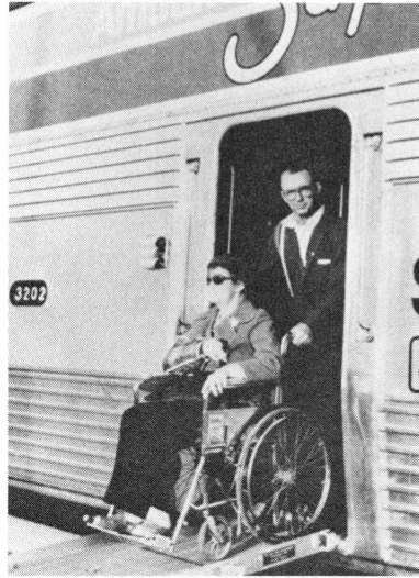
Fig. 1 アメリカのAmtrak急行列車に取り付けてある特別のランプ。 A special ramp carried aboard Amtrak Superliners (Paraplegia News, Feb., 1981より)
