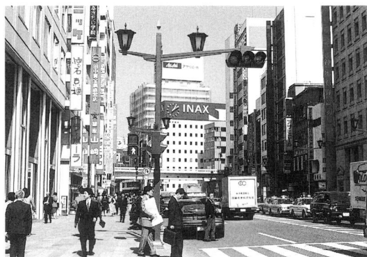
Fig.9 照明と信号機との共用例
