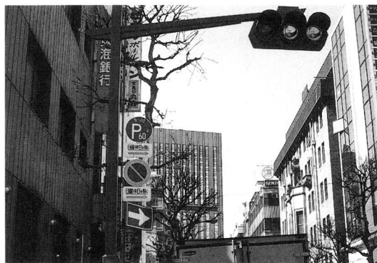
Fig.10 サイズを小さくして周囲との調和をはかった規制標識
