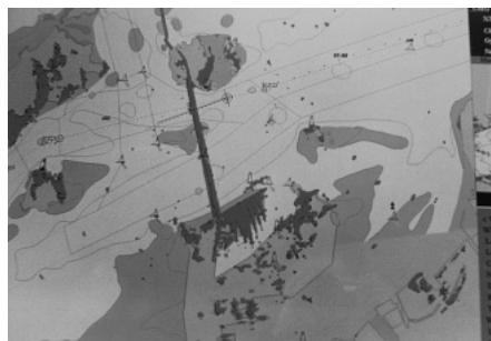
Fig.4 海図情報(基礎表示)とレーダ映像(緑色)との重畳
