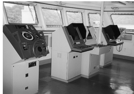
Fig.2 ブリッジに配置されたECDIS (中央): 操舵輪のすぐ隣に配置されている
