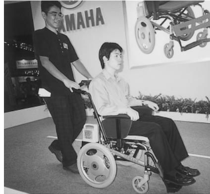
Fig. 8 介助者のための電動アシスト機能を備えた車いす
