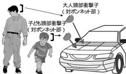
出典) 参考文献5) をもとに作成。 Fig. 3 日本の歩行者保護規制(Phase 1)の概念図
