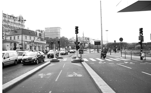
Fig. 8 車道中央の双方向自転車道（パリ）
