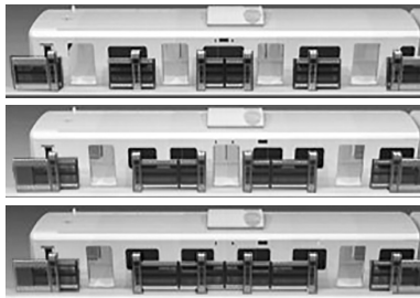
Fig. 8 マルチドア対応ホームドア (上から4ドア、3ドア、2ドア対応)
