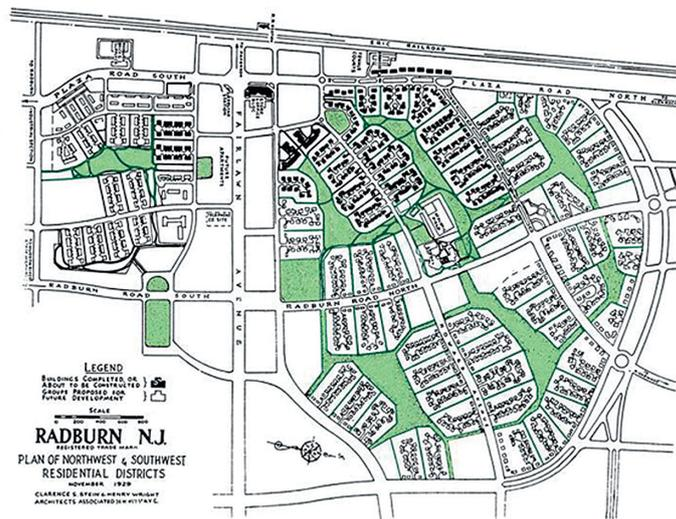
図1 ラドバーン住宅地での歩車分離動線
