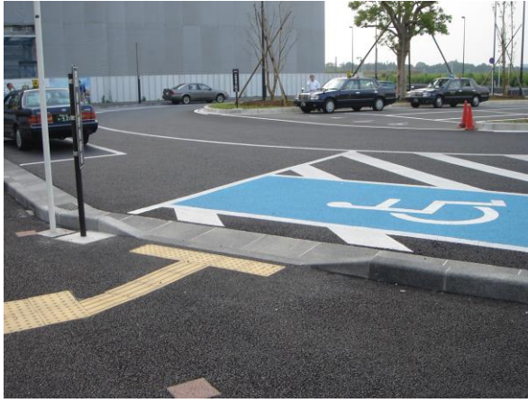
17-3 障害者用乗降スペースも車いす使用者の乗降のための設備であるため、点字ブロックを設置してはならない。（つくばエクスプレス線柏の葉キャンパス駅）
