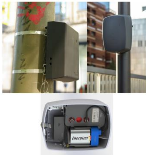
Fig. 1 PYRO-Box の外観及び内面構造 (左上図：旧型 宇都宮大学所有、 右上図：新型 宇都宮市役所所有 下図：内部構造)
